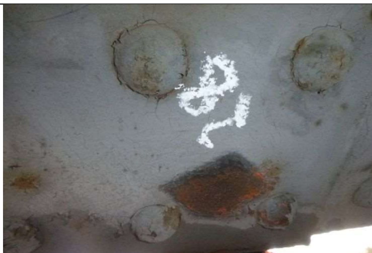
Obr. 109 – Měření tvrdosti dle Brinella
