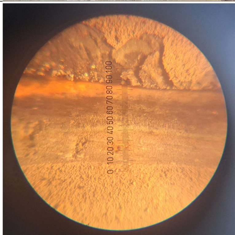
Obr. 131 – Pohled na souvrství nátěrového systému (vrchní vrstva je základní nátěr, spodní vrstva je vrchní nátěr), velikost jednoho dílku je 5 \mu m
