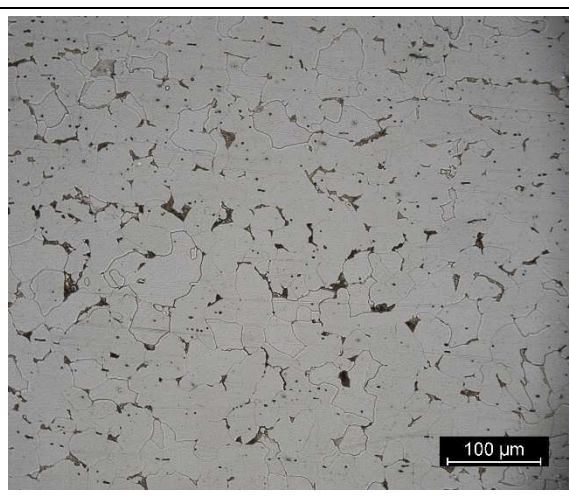
Obr. 113 – mikrostruktura NK2-1, příčný směr
